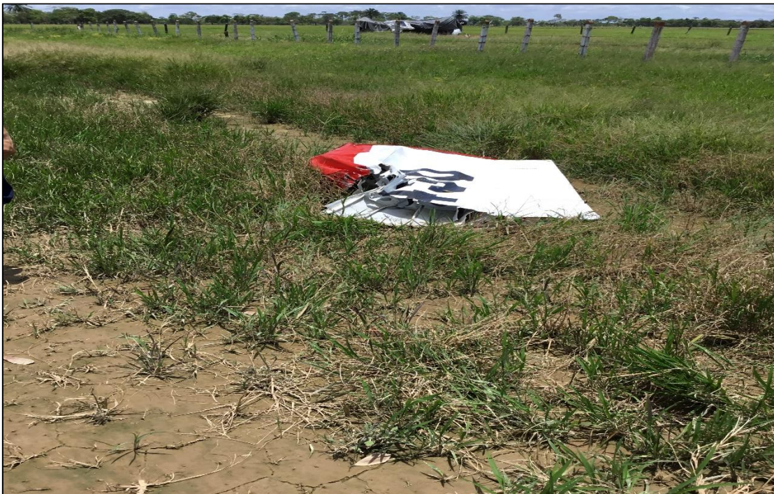
Imagen No. 2 –parte de plano desprendido después del impacto con el árbol
